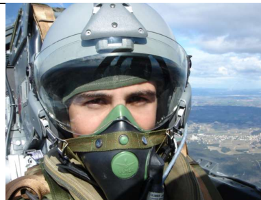
Figure 2a : casque d'avion de chasse sans visière solaire
